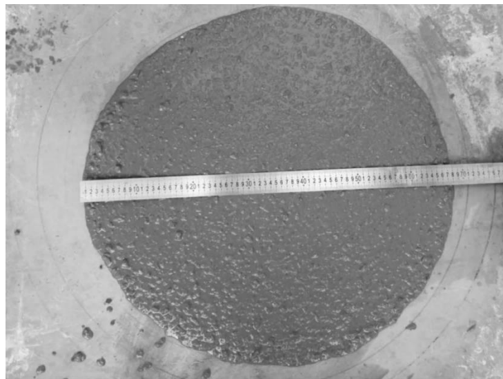
自密实混凝土
